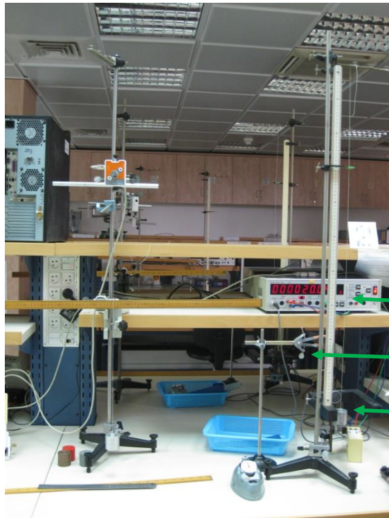
תמונה מס' 1: מערכת הניסוי - מטוטלת מתמטית
